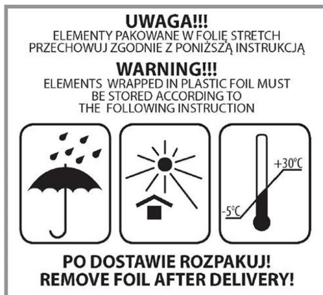
Rys. 10 Wytyczne do składowania profili krawędziowych zgodnie z naklejką nanoszona na opakowanie z profilami.
