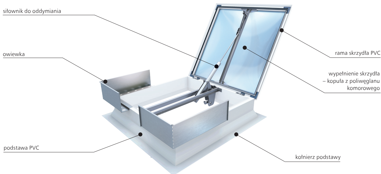
Rys. 147 – Budowa klapy oddymiającej mcr THERMOLIGHT PLUS NG-A wyposażonej w owiewki, ze sterowaniem pneumatycznym do oddymiania
